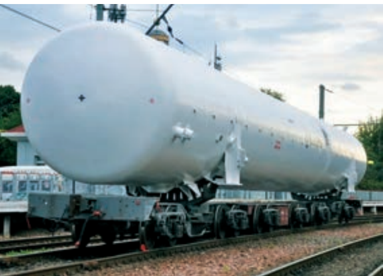
Железнодорожная криогенная цистерна для транспортировки жидкого водорода Источник: profitsteel.ru
