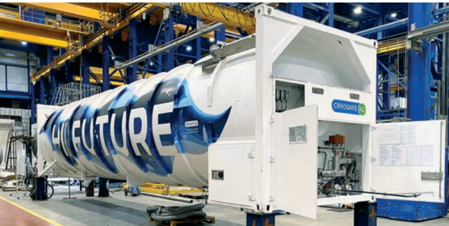
Контейнер-цистерна CryoSafe-42 для перевозки сжиженного водорода
