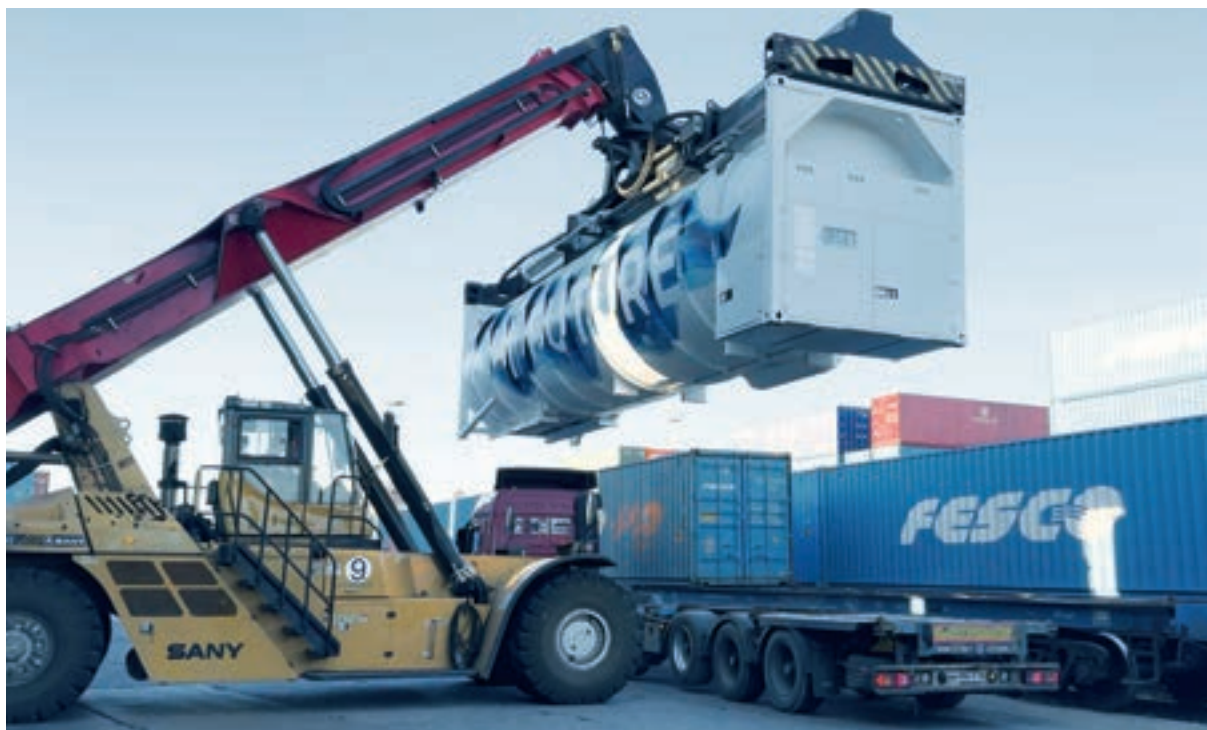
Установка контейнера-цистерны на грузовую платформу
