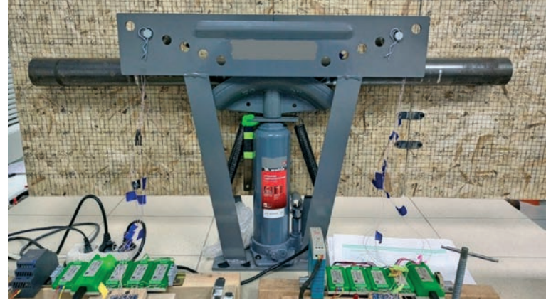
Рис. 1. Стенд для моделирования изгибающей нагрузки на трубу и измерения ее деформаций
