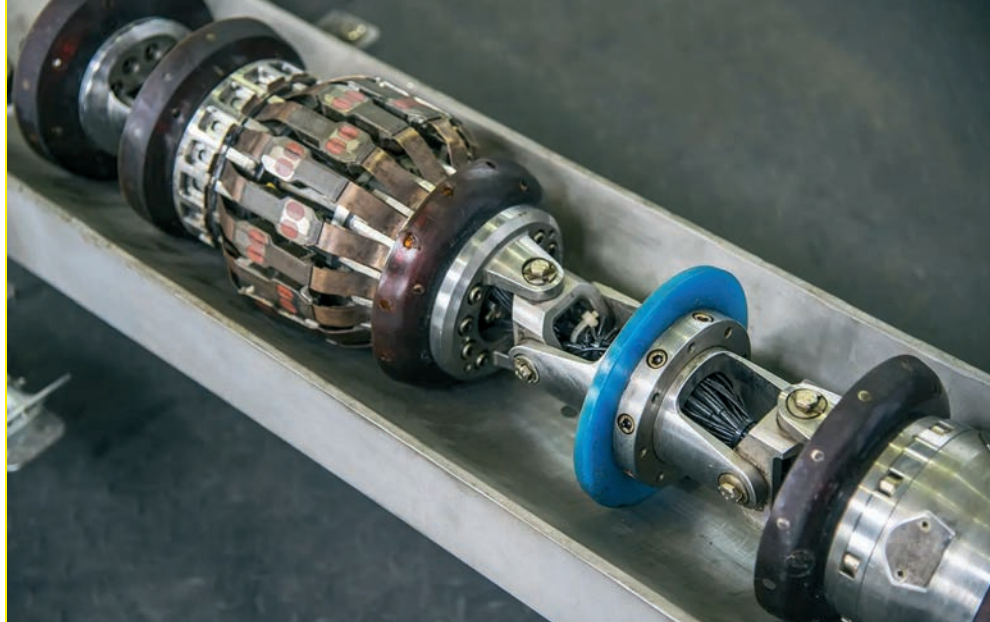
Магнитная система для диагностики толстостенных трубопроводов АО «Транснефть-Диаскан» Источник: diascan.transneft.ru
