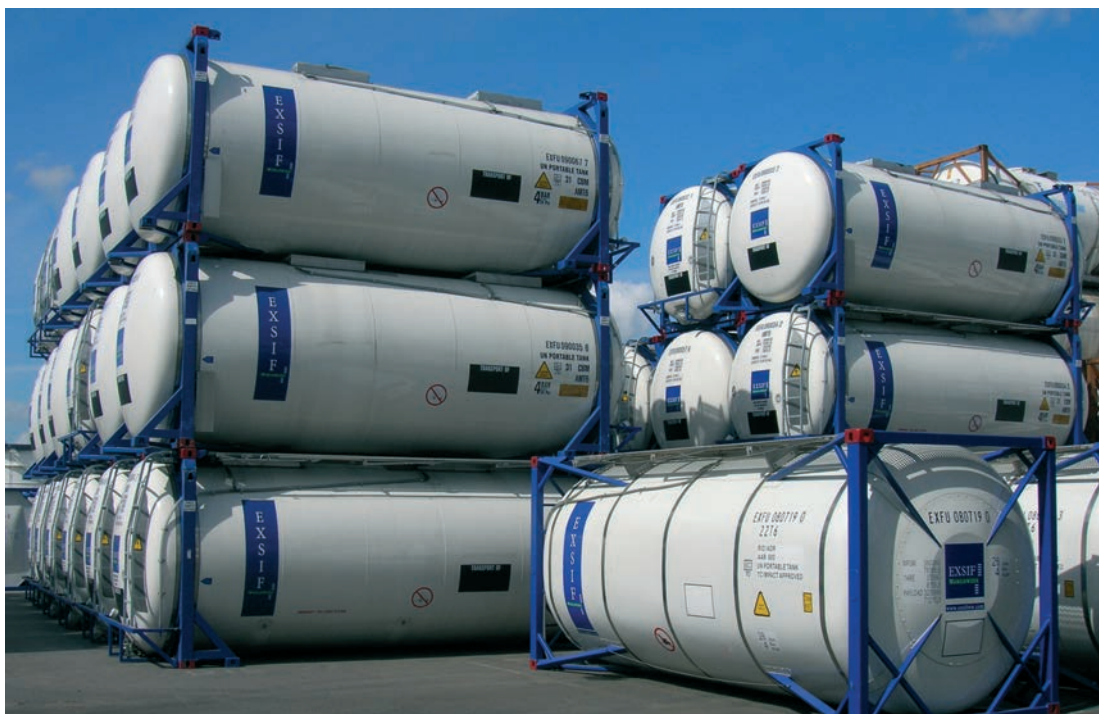
Контейнер для хранения водорода
